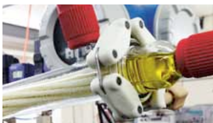
Testaufbau: weiss die röhrenförmigen Membranen.
