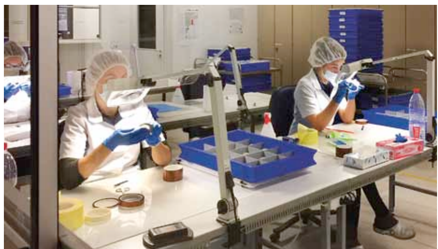
In staubfreier Umgebung: Alle Implantatflächen, die nicht beschichtet werden dürfen, werden abgedeckt.
