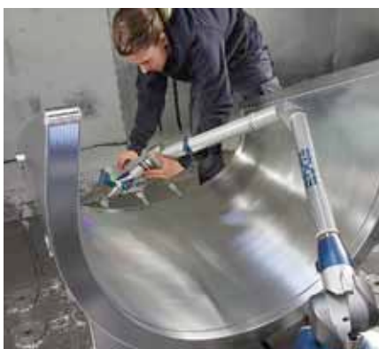
Gefräste Bauteile: Laser-Vermessung.
