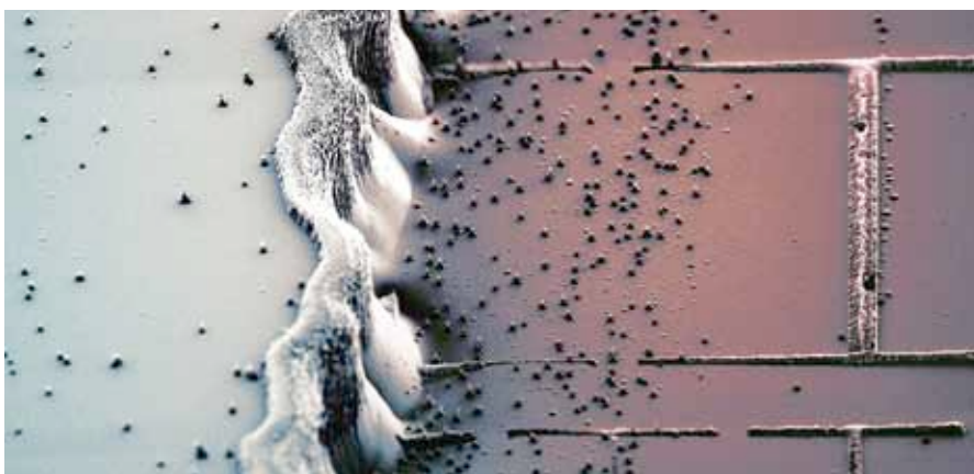
«Winterlandschaft»: Oberfläche eines Diamanten nach der Behandlung mit Plasma. Die rechteckigen Stücke können herausgebrochen und als Muster verwendet werden.
