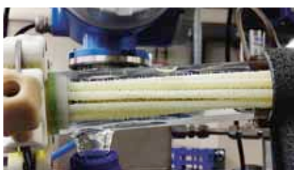
Membranen im Einsatz: Gasblasen treten aus.
