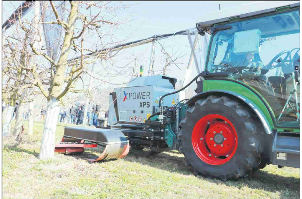
Mit Strom gegen Unkraut: Via Landi Sursee ist «X-Power» als Dienstleistung diese Saison im Obst- und Weinbau erhältlich. Am LZ Liebegg wurde die Maschine vorgeführt. (Bild Ruth Aerni)
