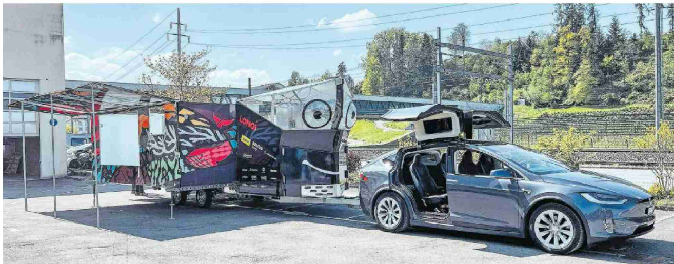
Auf Knopfdruck entfalten sich die Solarflügel: Bis gegen 300 Kilometer pro Tag kann der «Solar Butterfly» mit dem selbst produzierten Strom zurücklegen.
